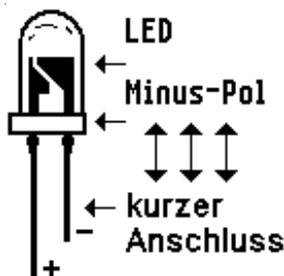
Bei der **Leuchtdiode (LED)** ist der kurze Anschluss der Minus-Pol. Beachte auch die weiteren Kennzeichnungen der Polarität im Bild! Die **LED** mit **Rv** kann auch an einem Kabel extern montiert werden.
