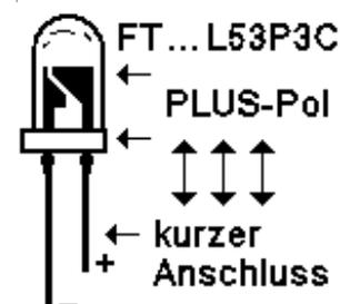
Im Gegensatz zur Leuchtdiode ist die Polung beim **Fototransistor FT** genau umgekehrt. Der kurze Anschluss ist der Plus-Pol. Siehe dazu auch die weiteren Polaritätskennzeichnungen auf dem Bauelement!
