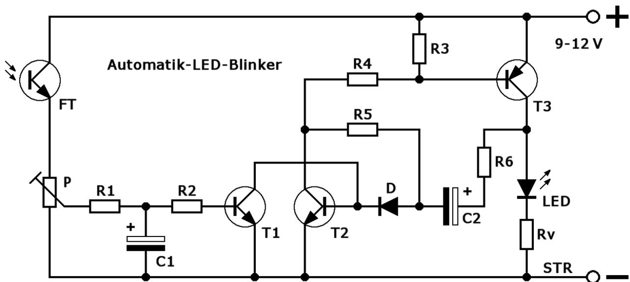
Der wesentliche Anwendungsbereich dieses LED-Blinkers wird wahrscheinlich die Verwendung als **optische Signalanlage** sein, welche sich bei Dämmerung automatisch einschaltet. Großer Wert wurde dabei auf einen **geringen Stromverbrauch** gelegt, sodass die Schaltung auch über einen langen Zeitraum mit einer Batterie oder Akku betrieben werden kann.
