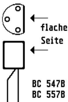
**T1, T2, T3:** Die abgeflachte Seite mit der Beschriftung ist im Bestückungsplan gekennzeichnet.
