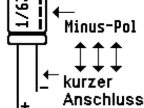
Bei **Elektrolyt-Kondensatoren** (radialen Elkos) entspricht der kurze Anschluss dem Minus-Pol. Siehe dazu auch die Kennzeichnung auf dem Bauelement!
